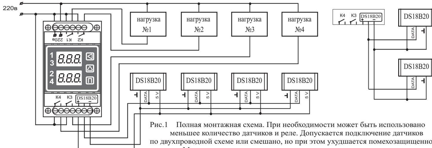
Рис.1 Полная монтажная схема. При необходимости может быть использовано меньшее количество датчиков и реле. Допускается подключение датчиков по двухпроводной схеме или смешано, но при этом ухудшается помехозащищенность системы. Мощные нагрузки желательно подключать через промежуточные реле.
